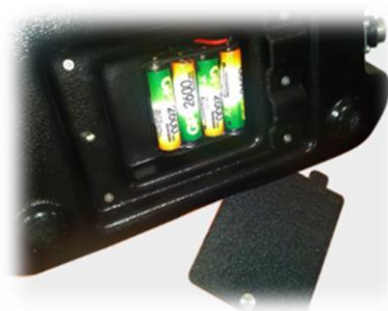
Рисунок 6 Размещение элементов питания в ПДУ.
